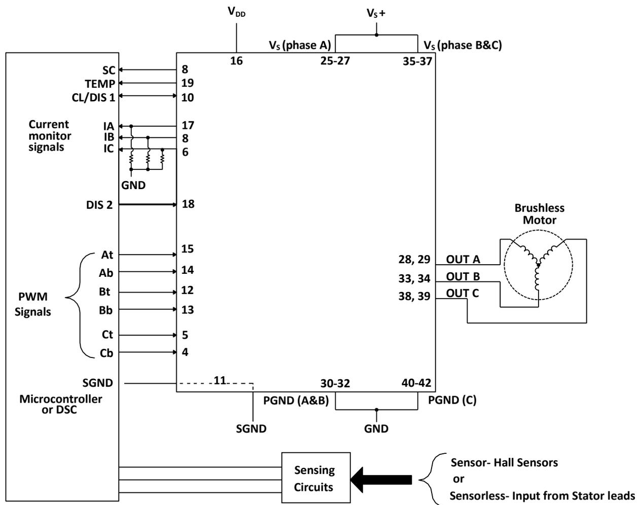
図14のブロック図は、SA306Aの入力構造と出力構造の特徴を示している。簡単にするため、単相を示している。
