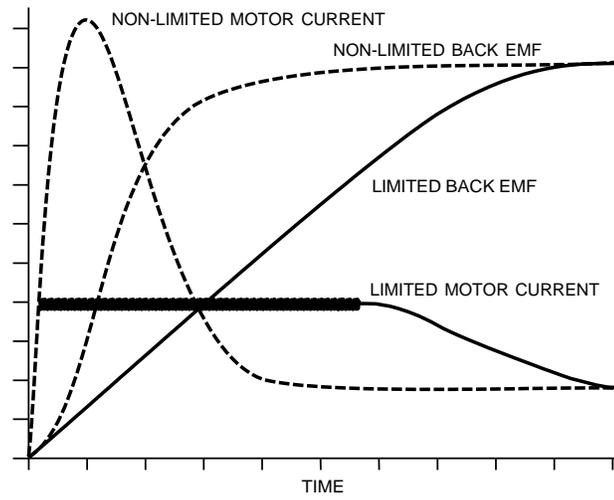
Figure 17: 電流制限波形
